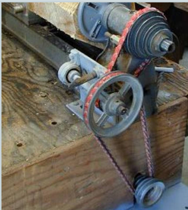
Понижение скорости. При точении неотбалансированных заготовок порой требуется пониженная скорость. Самодельный промежуточный вал понижает обороты шпинделя примерно до 400 об/мин. Эта скорость годится как для точения, так и для шлифования.
