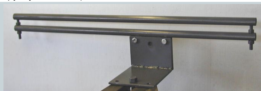
Стабилизатор момента. Стабилизатор устанавливается на место задней бабки. Чтобы использовать описанную систему на нескольких разных станках, стабилизатор сделан регулируемым по высоте.
