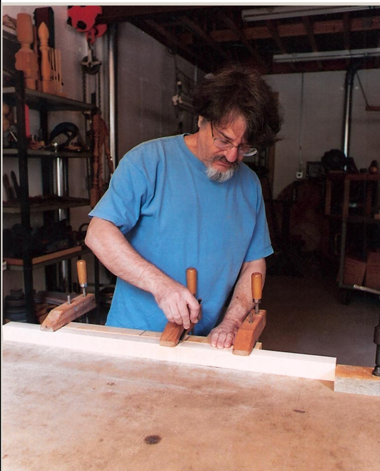
Фото 2. Приспособление для разметки линий переходов. Толщина заготовки немного меньше, чем упора, что позволяет свободно перемещать ее под деревянными струбцинами, которые выступают в качестве направляющих для нанесения линий.
