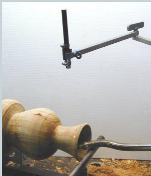
Начало выборки полости. Видимый на горловине лазерный луч следует за кончиком резца внутри сосуда.
