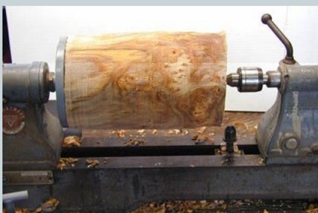
Начерно выточенный цилиндр. Заготовка грубо обточена до цилиндрической формы и готова к точению внешнего профиля.
