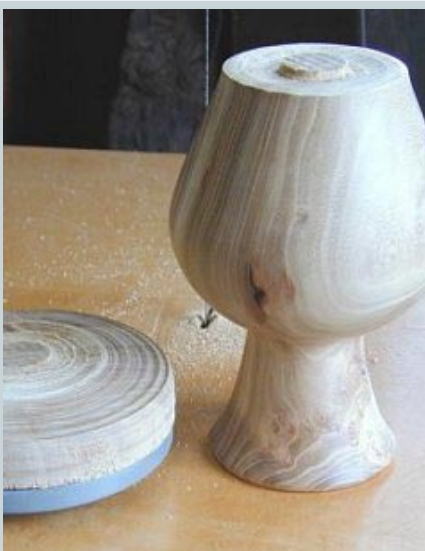
Отрезанный сосуд. Сосуд, отделенный от планшайбы с помощью ленточной пилы.
