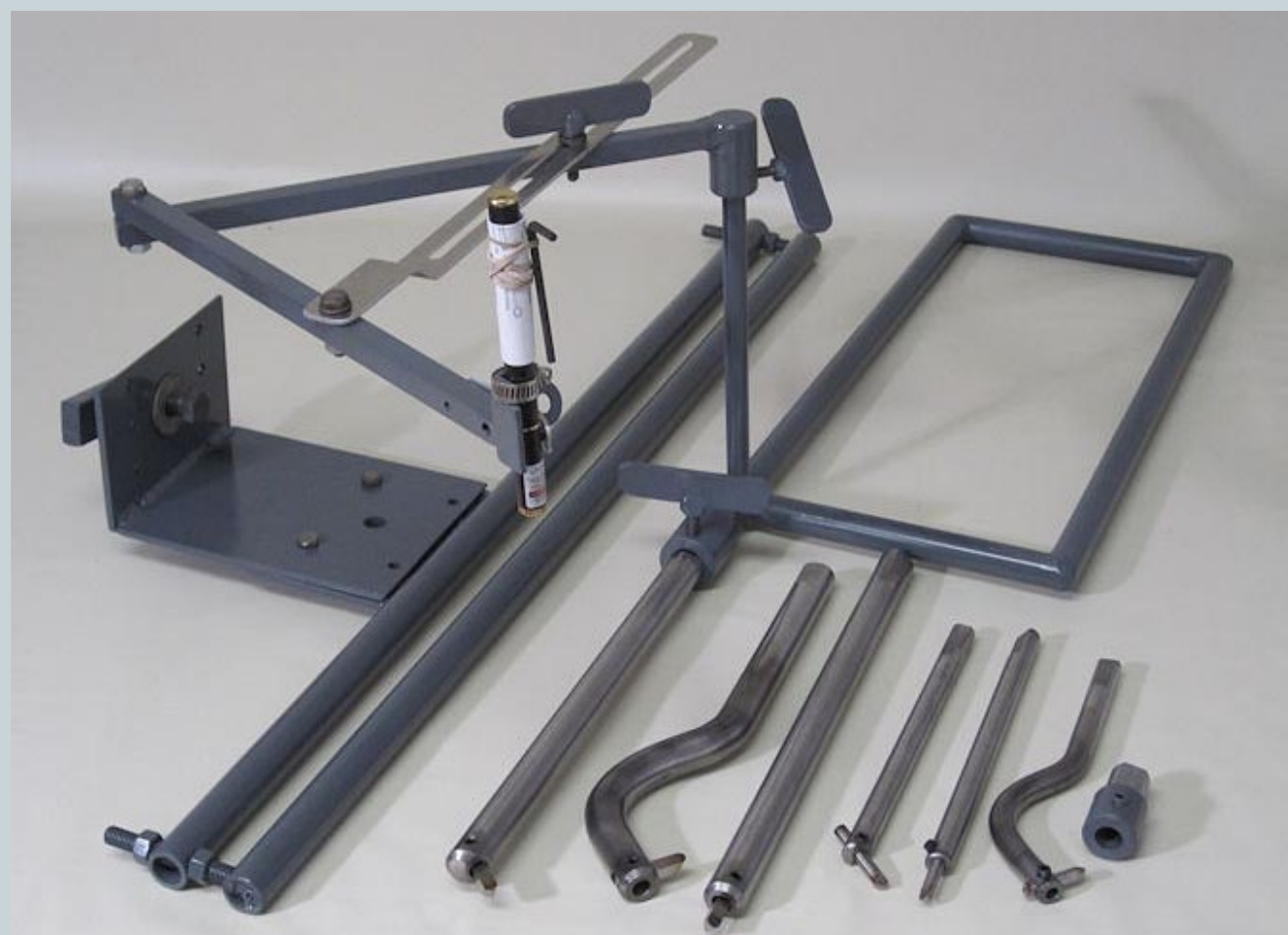
Инструменты для глубокого точения. Стабилизатор, D-образная рукоятка с закрепленной на ней лазерной указкой и набор сменных резцов - вот и все, что вам понадобится.
