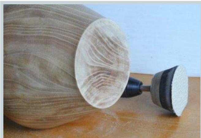
Шлифование доньшка. Доньшко сосуда, отшлифованное с помощью шлифовальной тарелки.
