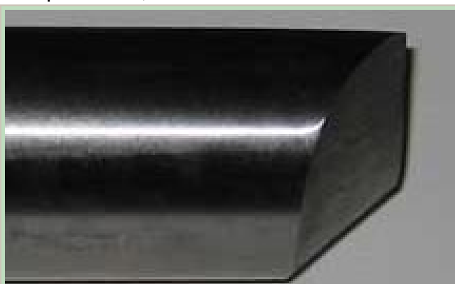
Этот резец шириной 25 мм имеет прямую поперечную заточку с углом заострения 40°.
