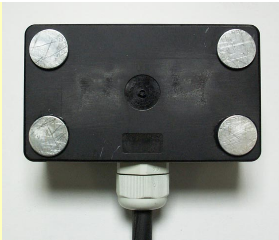
Фото 2. ... с помощью четырех магнитов, приклеенных с нижней стороны корпуса.
