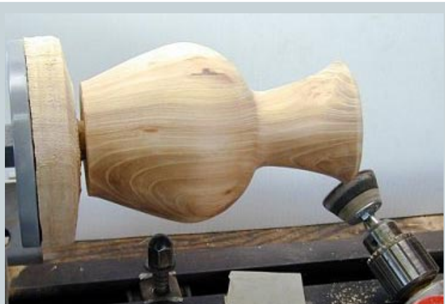
Шлифование внешней поверхности. Подсохший сосуд заново установлен на станок для шлифования с помощью губчатой шлифовальной тарелки, приводимой в действие электродрелью. Отшлифуйте также внутреннюю поверхность горловины сосуда, насколько это возможно, при помощи обычной шкурки. Для заключительного шлифования используйте шкурку с номером 600.
