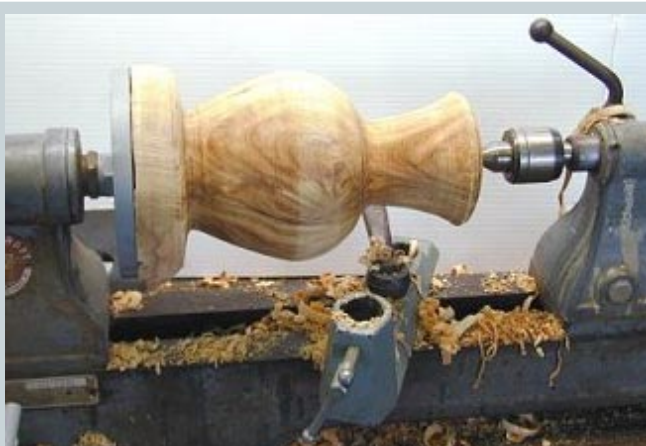
Придание формы. Подручник снят для лучшего обзора.
