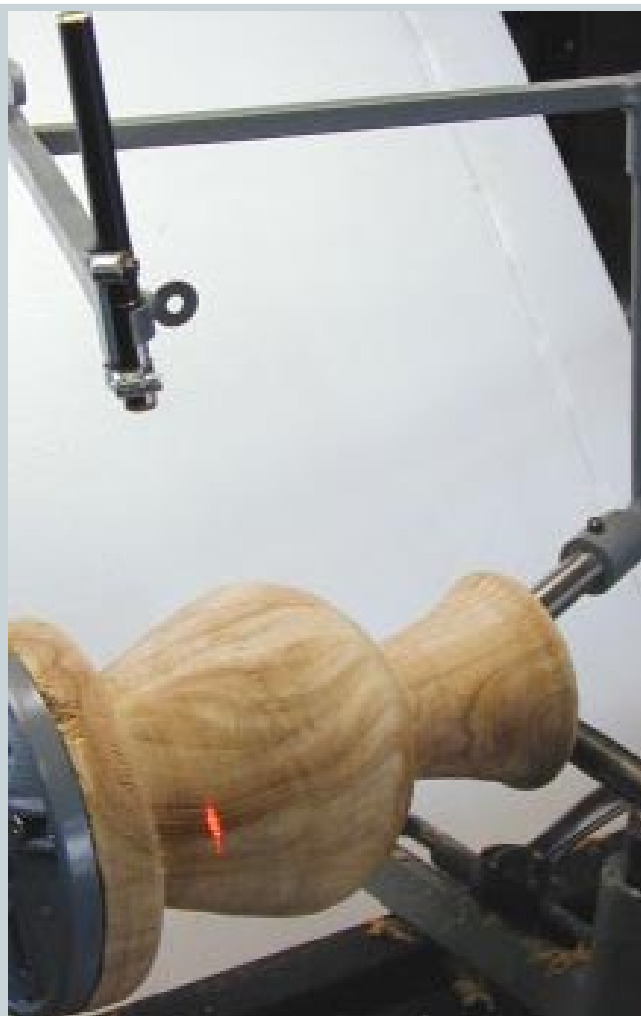
Завершение выборки полости. Кончик резца приближается к дну сосуда, и луч лазера показывает, что достигнута окончательная толщина стенок.
