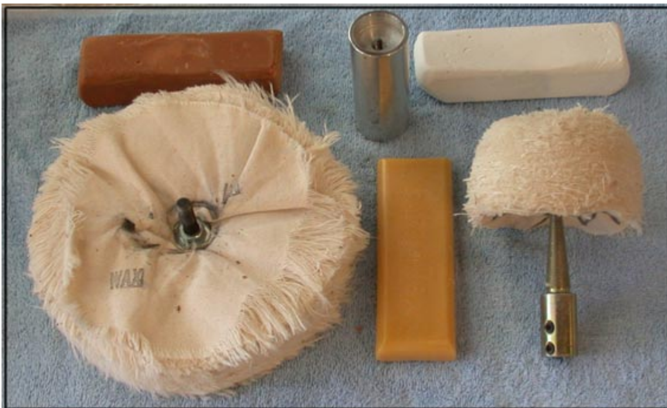
В типовой набор для полирования входят полировальные круги с монтажными оправками, пасты "трепел" и "белый алмаз" и карнаубский воск.
