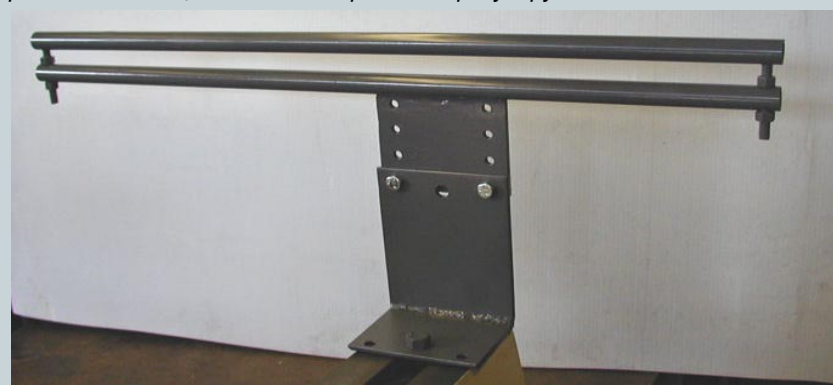
Стабилизатор момента. Стабилизатор устанавливается на место задней бабки. Чтобы использовать описанную систему на нескольких разных станках, стабилизатор сделан регулируемым по высоте.
