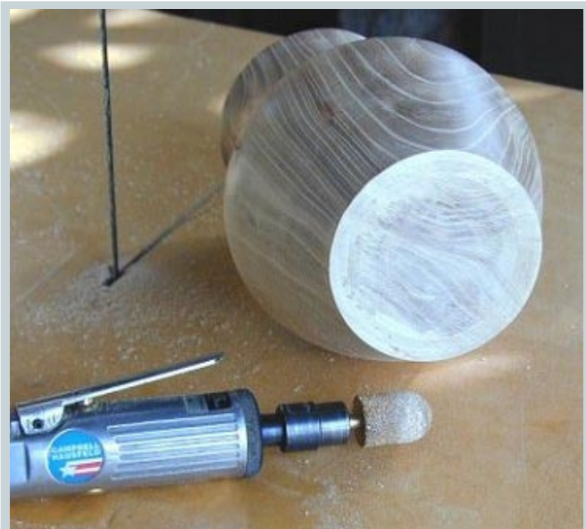
Подчистка доньшка. Для удаления последних следов шипа использована пневматическая шлифовальная машинка с абразивной насадкой и электроштансеска. Доньшку также следует дать подсохнуть в течение одного-двух дней.
