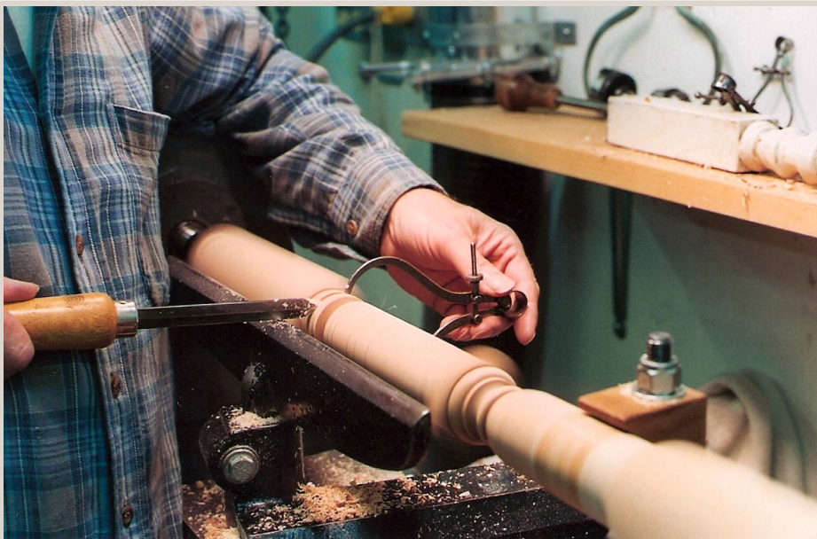
Фото 4. Работа с кронциркулем. Одной рукой держите отрезной резец, а другой кронциркуль. Приготовьтесь остановиться сразу же, как только кронциркуль "провалится".
