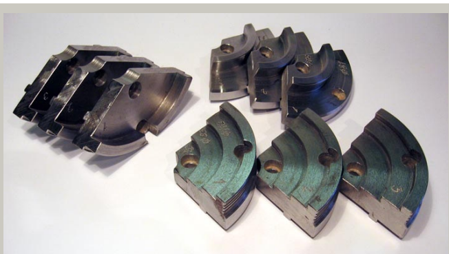
Фото 8. Различные виды кулачков, изготовленные автором.
