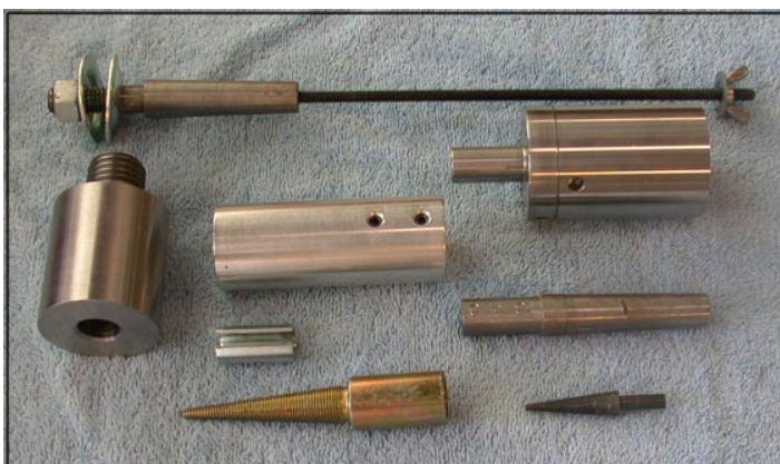
Для установки полировальных кругов на токарный станок или отдельный электродвигатель предлагаются различные оправки.
