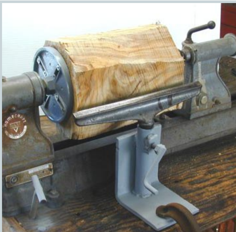
Установка заготовки на станок. Заготовка закреплена на планшайбе и поджата вращающимся центром задней бабки. Диаметр заготовки не позволил воспользоваться подручником, размещенным на станине, поэтому использован дополнительный подручник, прикрепленный струбциной к верстаку.
