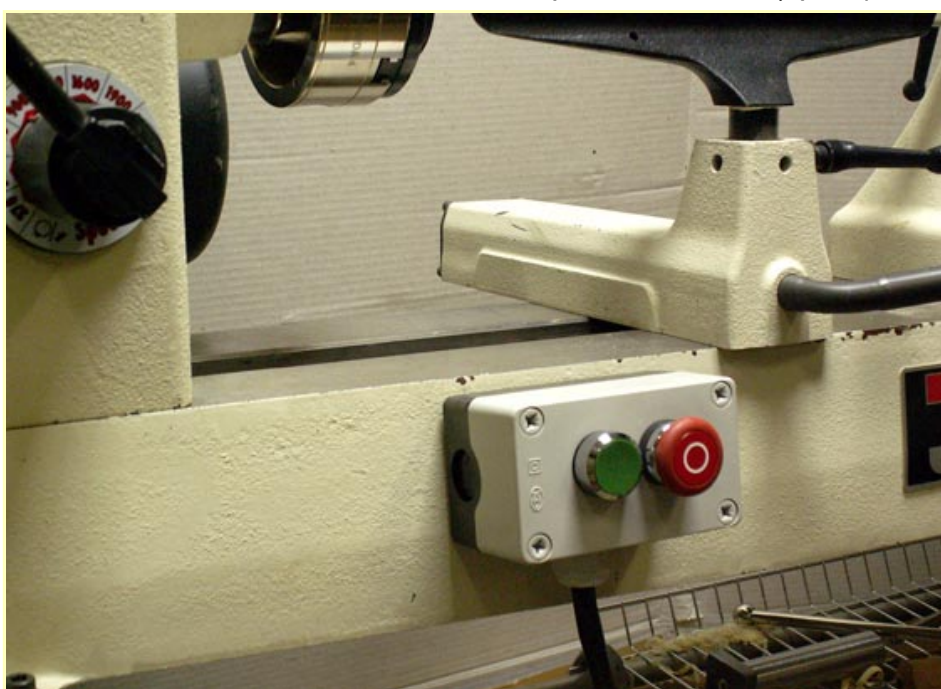
Фото 1. Кнопочный пост фиксируется на станке в любом удобном месте...
