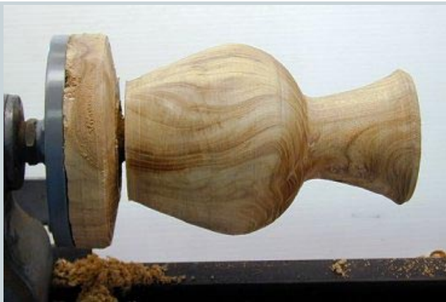
Формирование доньшка. Проточка, сделанная с помощью отрезного резца, оставила шип диаметром около 25 мм, соединяющий заготовку с планшайбой. На этой стадии сосуд вместе с планшайбой снимают со станка и оставляют подсохнуть в течение пары дней. Этот способ обеспечивает более равномерное высыхание доньшка сосуда.
