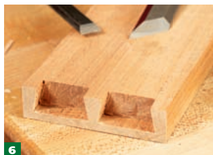
6 Два гнезда на передней стенке ящика выполнены безукоризненно.
