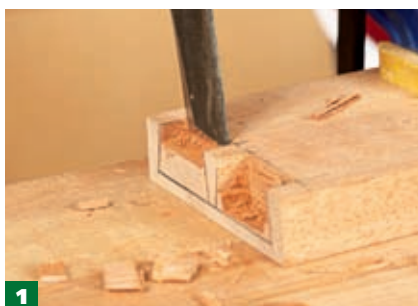
1 Обычной стамеской удаляйте древесину в гнездах для «ласточкиных хвостов», оставляя припуск около 1,5 мм.
