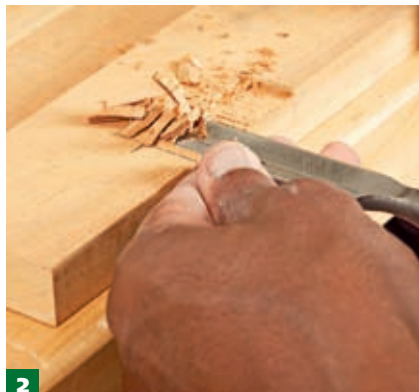
2 Держите стамеску параллельно поверхности детали и срежьте мелкие стружки.
