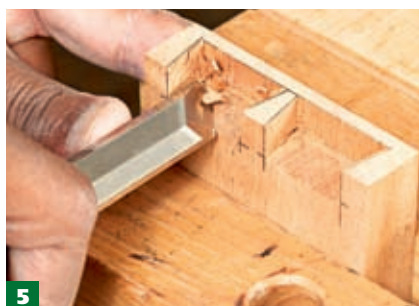
5 Наконiec косоj стамескоj зачистите внутренние углы гнезда.
