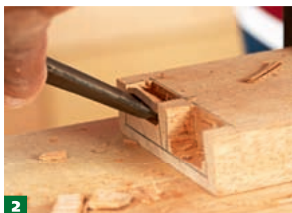
2 Сделав вертикальную зарубку, переверните стамеску и горизонтальным резом отделите щепку.
