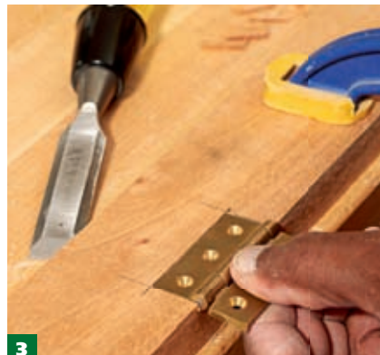
3 Легкими движениями зачистите и выровняйте дно и края углубления, добиваясь плотной посадки петли.
