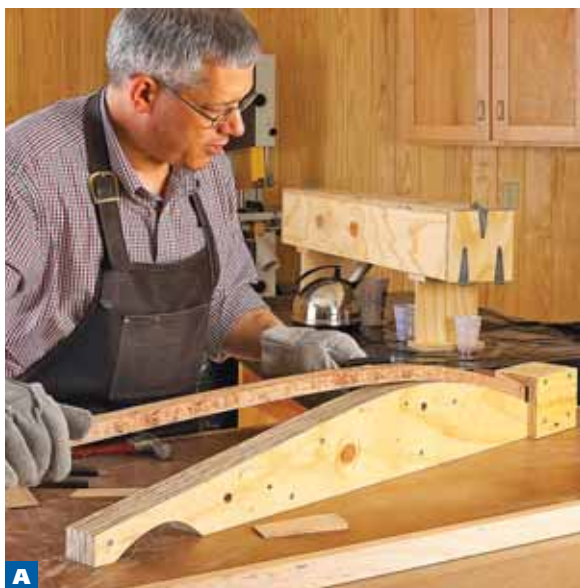
РИС. 2. ФОРМА ДЛЯ ГНУТЯ (ДЕТАЛЬНЫЙ ВИД)
