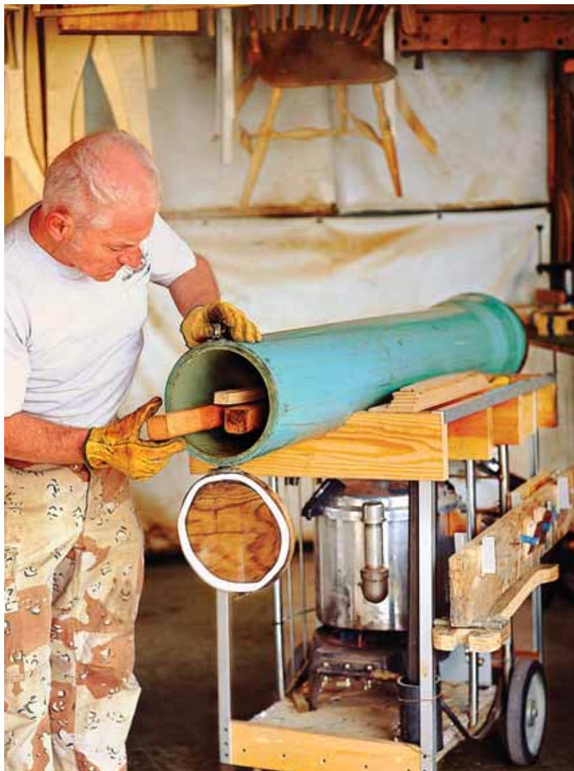
Паровая камера, бак для воды, горелка и опора для форм установлены на тележке, так их удобнее хранить, чтобы в любой момент быть готовым к гнутью.
