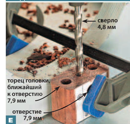
E Привернув головку к упору сверлильного станка, просверлите отверстие диаметром 4,8 мм на глубину 20 мм по отмеченному центру.
