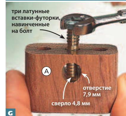
G Накидной головкой или гаечным ключом вверните болт М4 с накрученной вставкой-футоркой в дно 4,8-миллиметрового отверстия в головке А.
