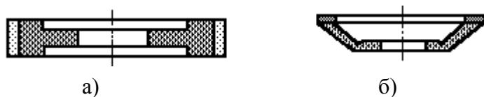
Рис.126. Круги алмазные: а) - прямого профиля; б) - чашечные
