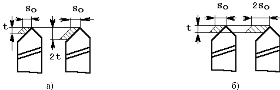
Рис.47.Изменение сечения срезаемого слоя при: а) увеличении глубины резания t ; б) - подачи S_o
