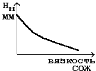
Рис.35. Зависимость H_H = f(\text{Вязкость СОЖ})
