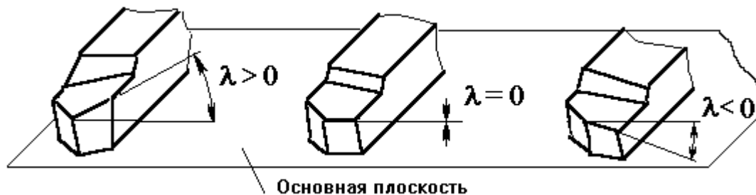
Рис.6. Угол наклона главного режущего лезвия
