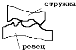
Рис.59.Схема контакта стружки с поверхностью резца
