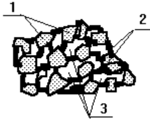
Рис.121. Строение шлифовального круга
