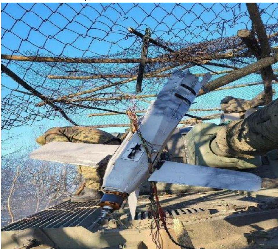
Рис. 3 Применение сетки-рабицы для защиты от мини- и микроБПЛА
