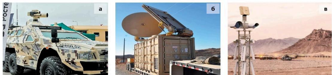
Рис. 6. Системы для борьбы с БПЛА: а – многофункциональный мобильный комплекс «Рать»; б – противодронная система Phaser; в – противодронная система DroneSentry
