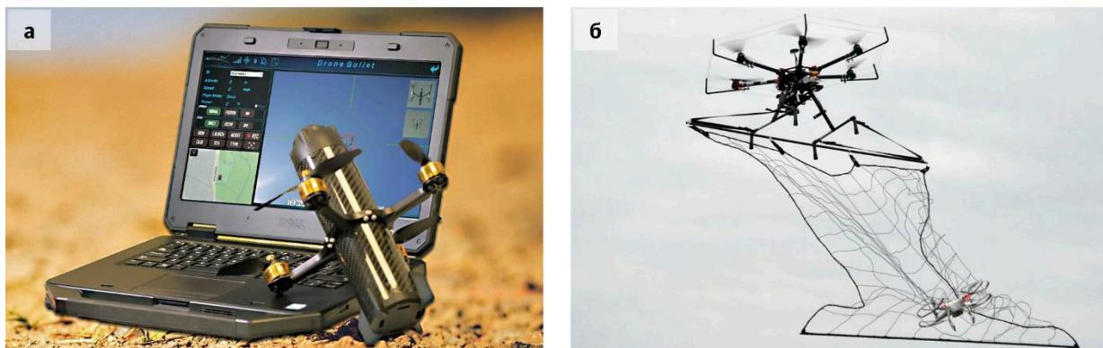
Рис. 2. Противодроновые беспилотники: а – дрон-камикадзе DroneBullet канадской AerialX; б – дрон-перехватчик с сетью
