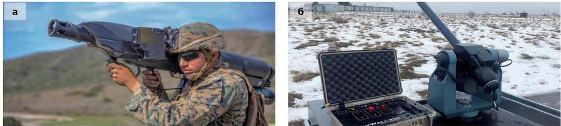
Рис. 3. Британские системы: а – оператор с комплексом SkyWall 100; б – турель SkyWall 300 для запуска снаряда с сетью
