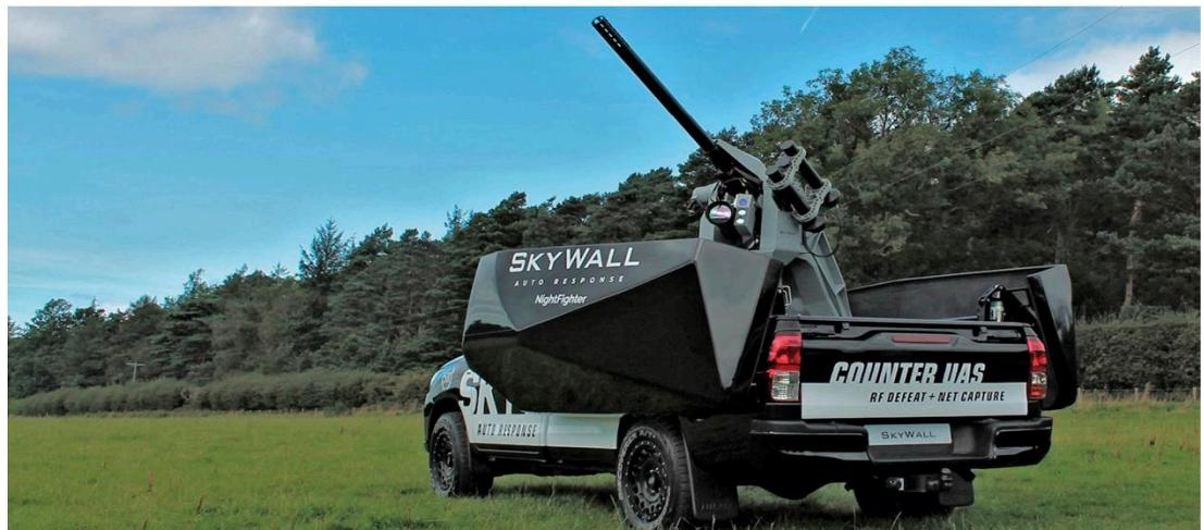
Рис. 4. Система SkyWall Auto Response для запуска снаряда с сетью
