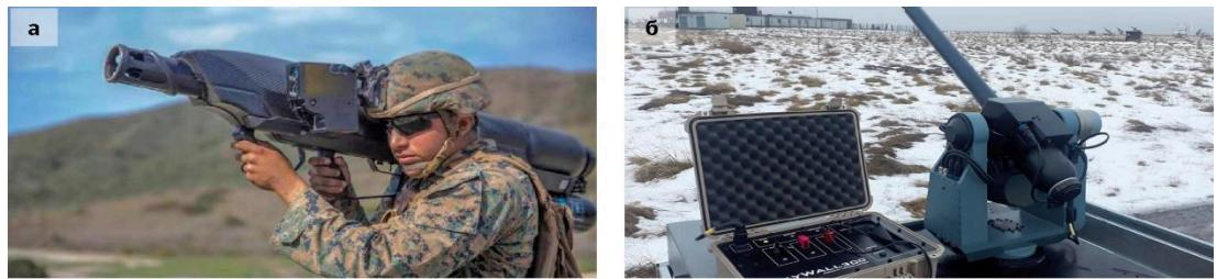
Рис. 3. Британские системы: а – оператор с комплексом SkyWall 100; б – турель SkyWall 300 для запуска снаряда с сетью
