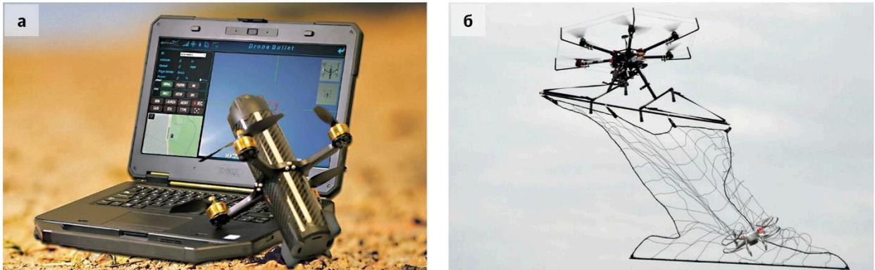
Рис. 2. Противодроновые беспилотники: а – дрон-камикадзе DroneBullet канадской AerialX; б – дрон-перехватчик с сетью
