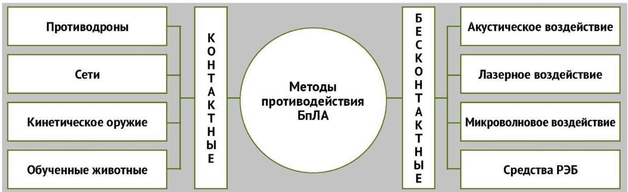
Рис. 1. Методы противодействия БПЛА
