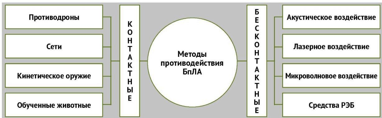
Рис. 1. Методы противодействия БПЛА
