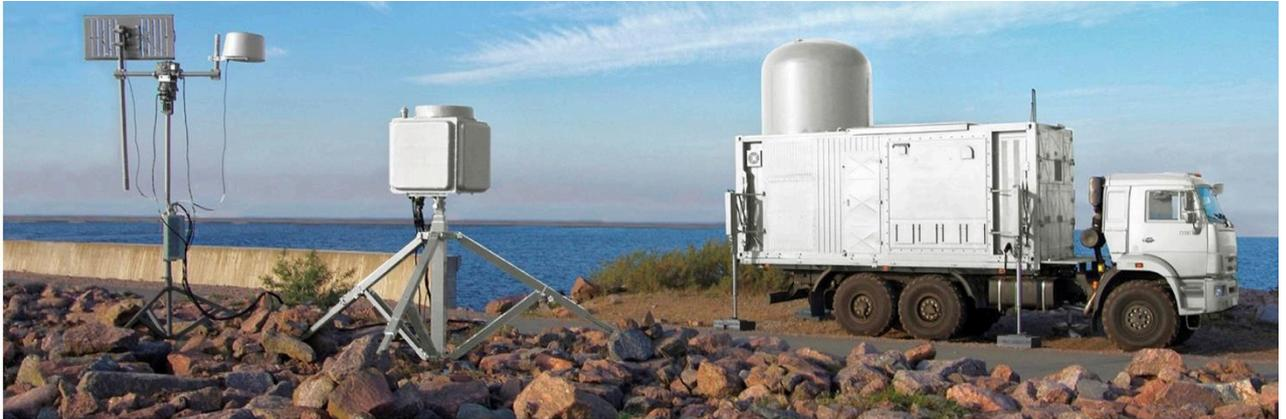
Рис. 7. Радиолокационно-оптический комплекс обеспечения безопасности объектов и нейтрализации БПЛА «Валдай»
