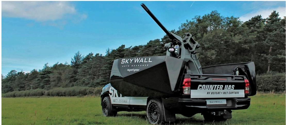
Рис. 4. Система SkyWall Auto Response для запуска снаряда с сетью
